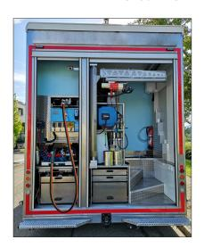
**SPECIALS:** DREIFACH Hybrid-Stromversorgung, DC-Generatorsystem Whisper Power, Batterie-Pack 8x GEL-Batterie 24V 900Ah, Solaranlage 1710 Watt auf Kofferdach
